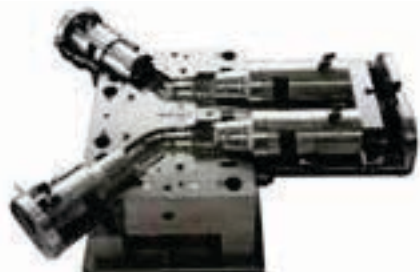
Extrusion-soufflage de conduits à formes complexes en polyalphaoléfinés, pour l'aéronautique
