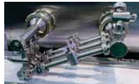
Lubrification de roulements de système d'entraînement de convoyeurs à tapis
